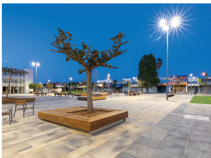
אריחי ריצוף 30/60, 60/60 בגימור אומבריאנו, כיכר העיר קריית מלאכי, סולסי גרשון-אדריכלים, שלומי גנות אדריכל
